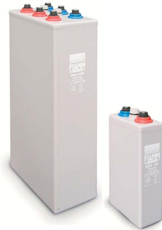
Le batterie piombo acido **FIAMM** della serie **SMG** sono del tipo regolate da valvola con elettrolito immobilizzato in forma gelatinosa. Le piastre positive sono di tipo tubolare con lega piombo - calcio. I collegamenti tra gli elementi sono completamente isolati. L'innovativo passaggio polare ad alta affidabilità garantisce assenza di corrosione durante tutta la durata di vita dei prodotti.
